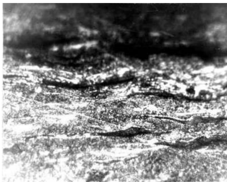
Рис. 3 – Текстурирование поверхностного слоя чугуна ВЧ60-2
