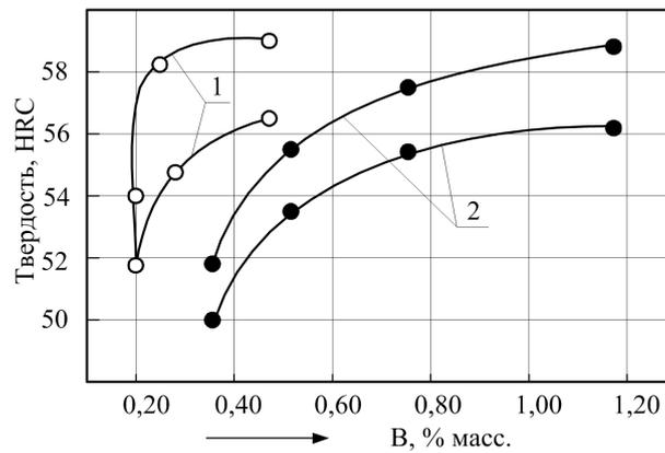
**Рис. 1** – Зависимость твердости наплавленного металла от концентрации бора и титана:
