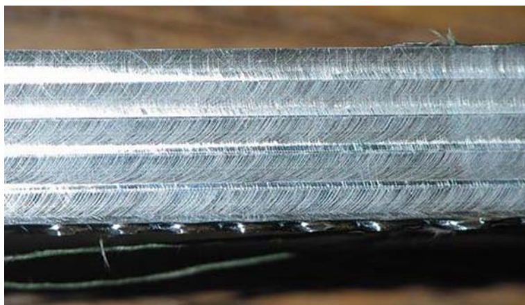
Рис.6 - Дроблення на обробленій поверхні в результаті вібрацій інструмента
