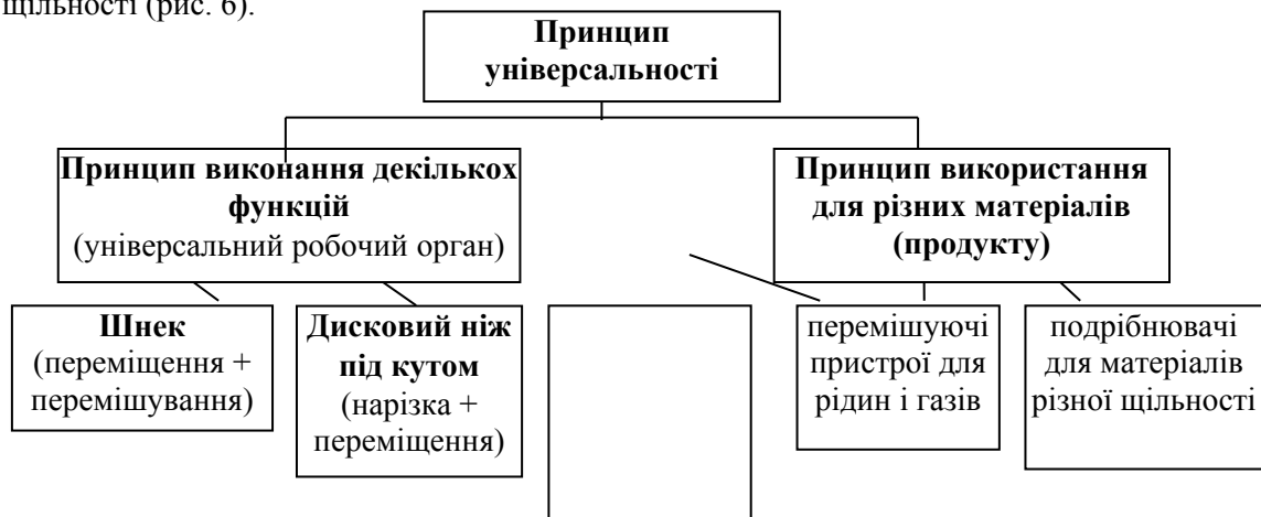
Рис. 6 Конкретизація та деталізація принципу універсальності для предметної галузі процесів та апаратів хімічних виробництв
