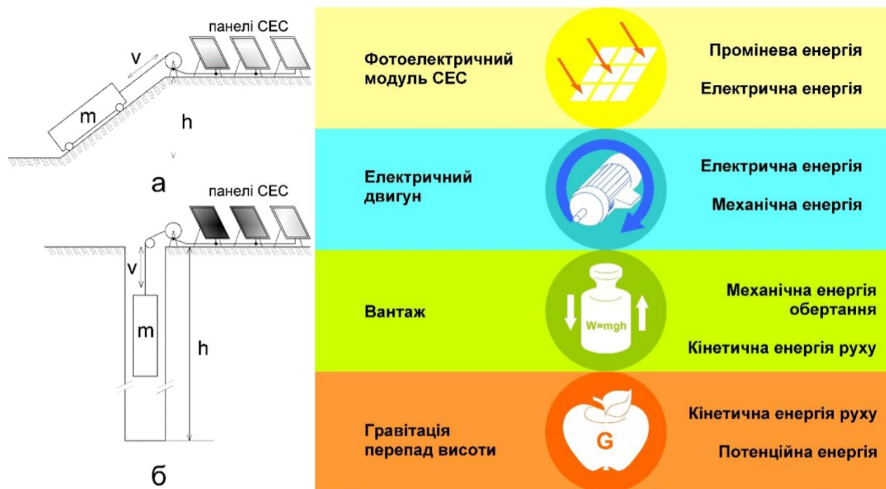
Рис. 1 Принципові та структурно-логічна схеми комплексу СЕС з ГНЕ а – териконно-кар’єрне виконання, б – шахтне виконання
