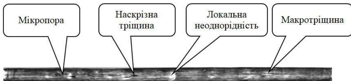
Рис 3.1. Вигляд експериментального зразка трубки – імітатора фізичної моделі ТВЕЛ з різними ушкоджуючими дефектами на поверхні оболонки
