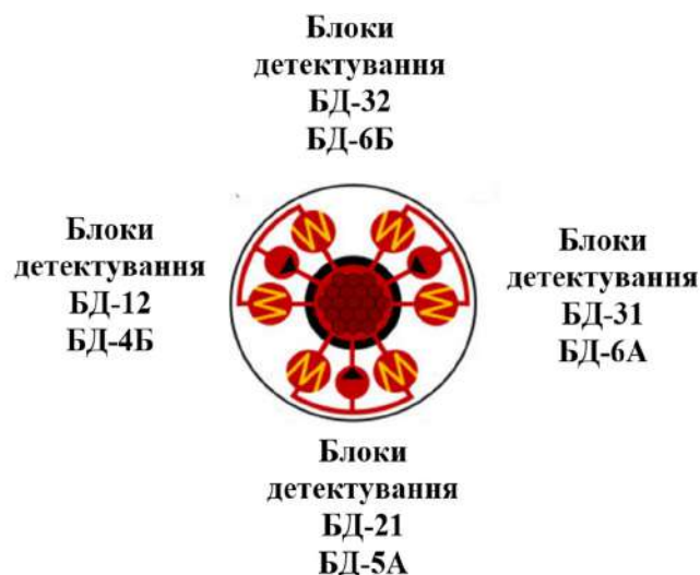
Рис. 1.18. Розташування блоків детектування ССКГО БН-800 і БН-600
