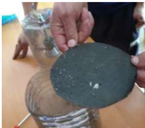
Рисунок 2 – Отражатель ультразвуковых волн после работы экспериментальной установки ультразвуковой очистки выхлопных газов
