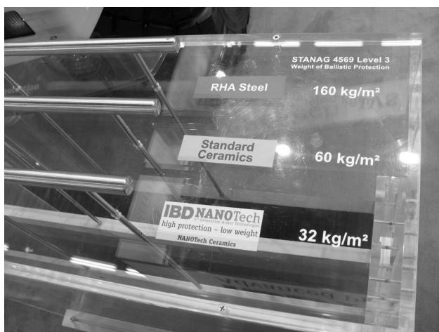
Рис. 4 – Порівняльні зразки катаної гомогенної сталі, звичайної кераміки й нового матеріалу IBD NANOTech
