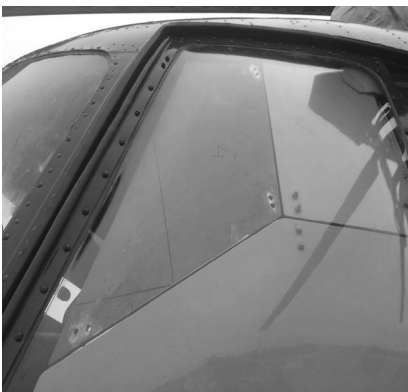
Рис. 2 – Встановлення броньованих плит в кабіні вертольота
