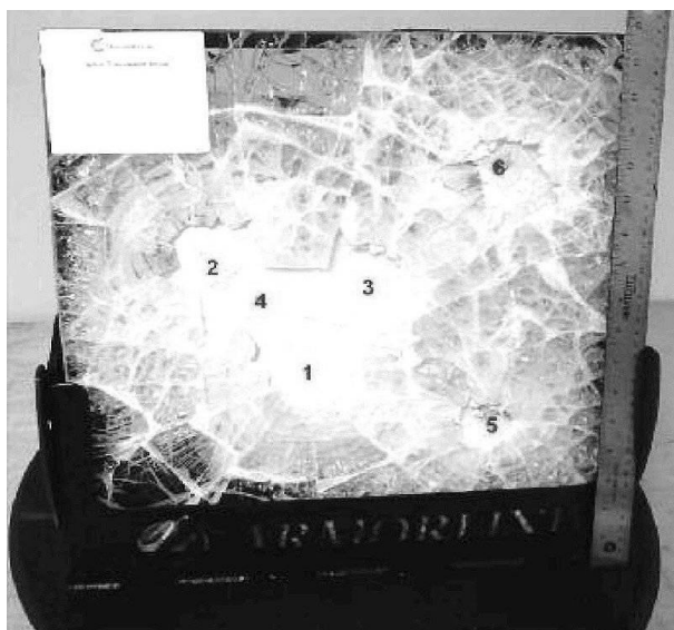
Рис. 5 – Багатошаровий прозорий захист 400 x 400 мм, виготовлений з використанням шпінелі від ArmorLine, після шести пострілів
