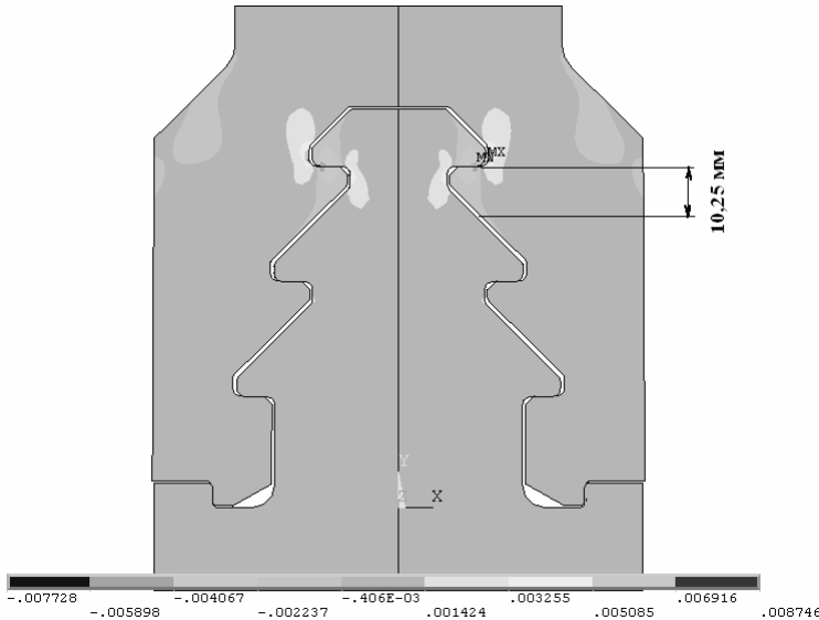
Рис. 1 – Распределение относительных деформаций при контакте верхней опоры зубцов
