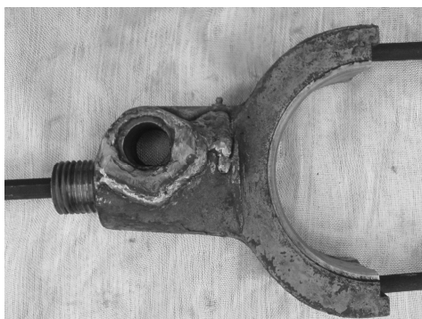
Рис. 2 – Приклади ремонтного зварювання чавунних деталей
