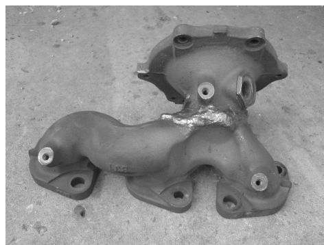
Рис. 2 – Приклади ремонтного зварювання чавунних деталей
