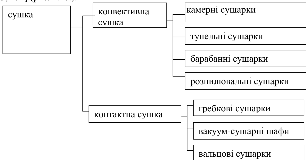
Рис. 2.18. Обладнання процесу сушки
