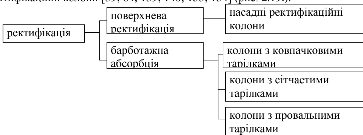
Рис. 2.19. Схема обладнання процесу ректифікації
