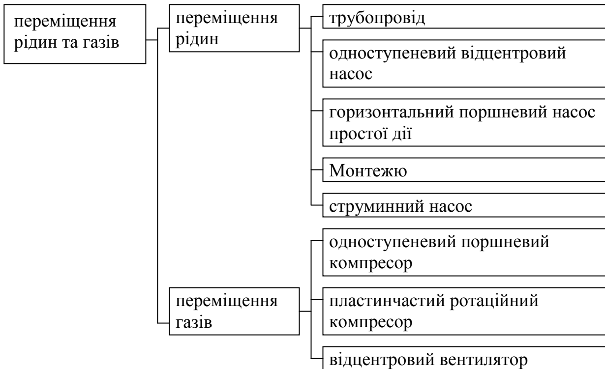
Рис. 2.12 Обладнання процесу переміщення рідин та газів
