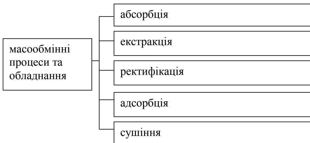
Рис. 1.13. Масообмінні процеси та обладнання
