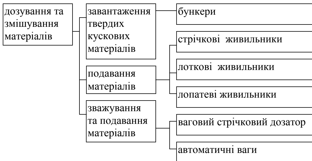
Рис. 2.10. Обладнання процесу дозування та змішування матеріалів
