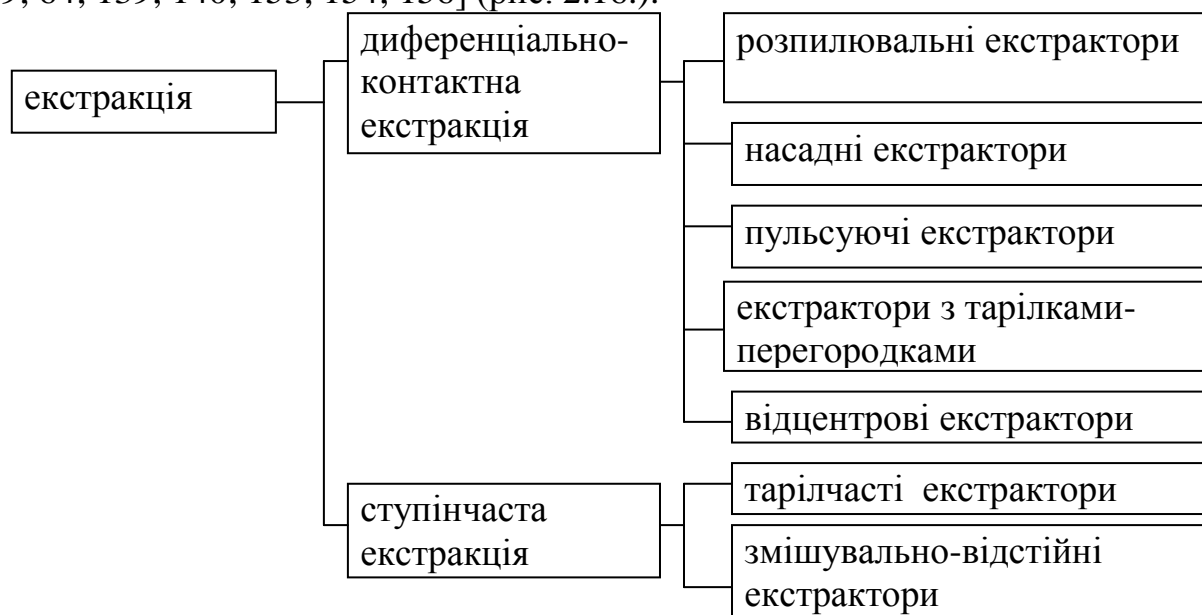
Рис. 2.16. Схема обладнання процесу екстракції
