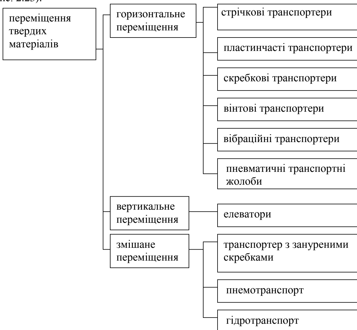
Рис. 2.23. Обладнання процесу переміщення твердих матеріалів горизонтальним, вертикальним та змішаним способом
