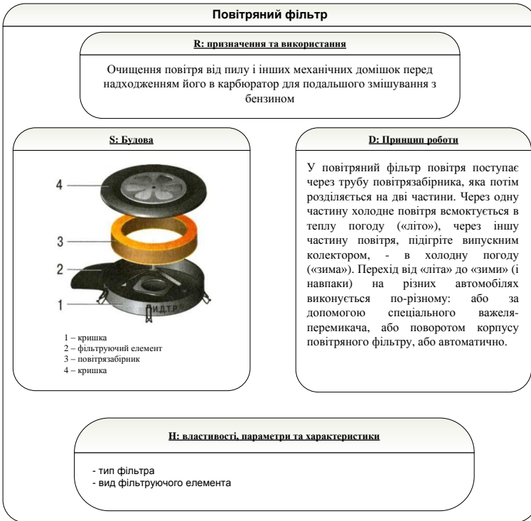
Рис. Д.5. Рекурсивна модель представлення поняття «повітряний фільтр»
