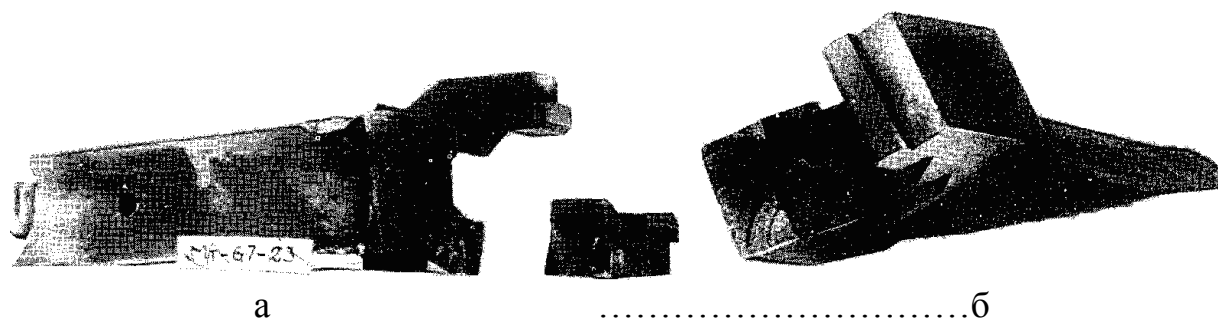
Рис. 1. Повреждения хвостовиков лопаток 5-й ступени РСД турбины К-300-240 на уровне верхней и нижней опор обода: а – повреждение на уровне верхней опоры обода; б – повреждение на уровне нижней опоры обода
