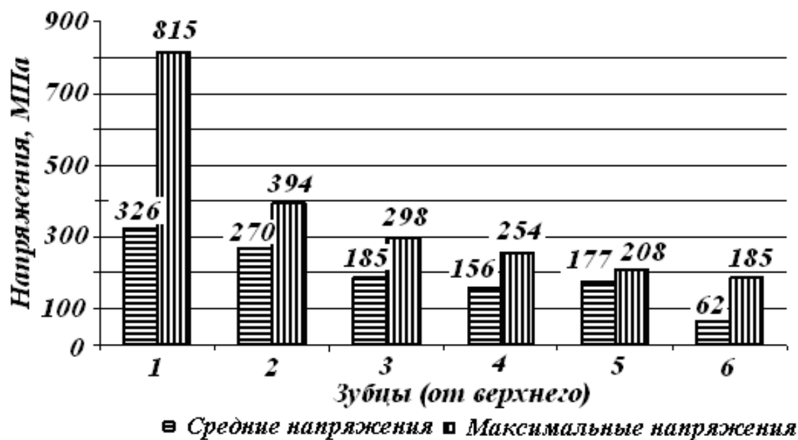
Рис. 5 - Распределение средних и максимальных напряжений в сечениях хвостовика
