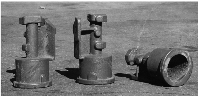
Рис. 1 – Отливка «Корпус цилиндра выключения сцепления» для грузового автомобиля КрАЗ
