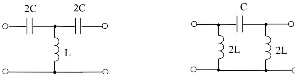
Рис. 8.4. Фильтр верхних частот типа  $K$
