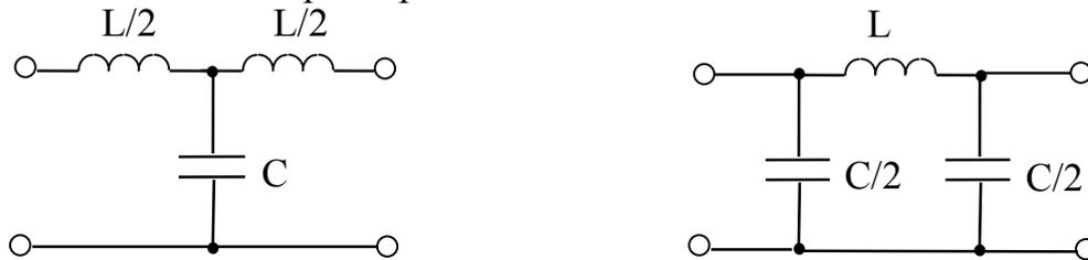
Рис. 8.3. Фильтр низких частот типа  $K$
