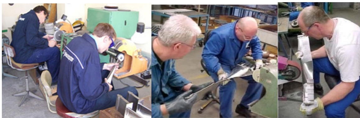
Рис. 2 – Ручной способ шлифования лопаток
