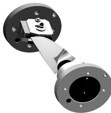
**Рис. 3** – Шарнирное станочное приспособление для крепления лопатки
