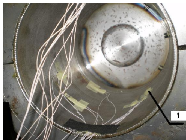
Рис. 2 – Канатный барабан (расположение измерительных тензорезисторов)
