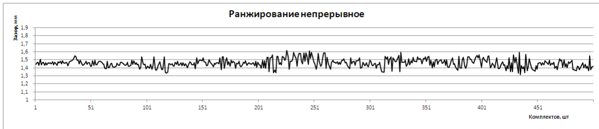
Рис. 3. Разброс размеров замыкающего звена при дискретном а) и непрерывном б) комплектовании с ранжированием, величина партий / комплектов равна 10
