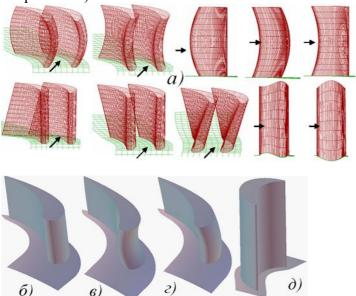
Рис. Различные виды трехмерных лопаток: а) саблевидно-серповидные, стреловидные, с волнообразной поверхностью по ограничивающих поверхностей (стрелка показывает направление входящего потока); б) базовый вариант сопловой лопатки; в) сопловая лопатка с саблевидной входящей кромкой; г) сопловая лопатка со серповидной входящей кромкой; д) цилиндрическая рабочая лопатка.
