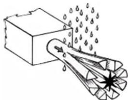
Высокоскоростное формование привело к появлению принципиально нового типа микронитей или микроволокон с диаметром элементарных нитей 6 - 9 мкм.
