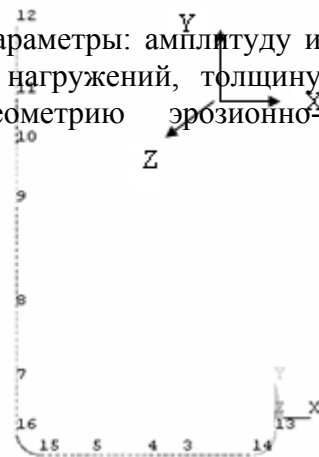
Рис.2.6. Стержневая модель трубопровода ГЦТ.
