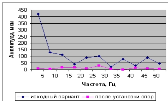
Рис.3.16. Диаграмма амплитуд колебаний трубопровода ПНД-3 в ПНД-4 до и после установки дополнительных опор
