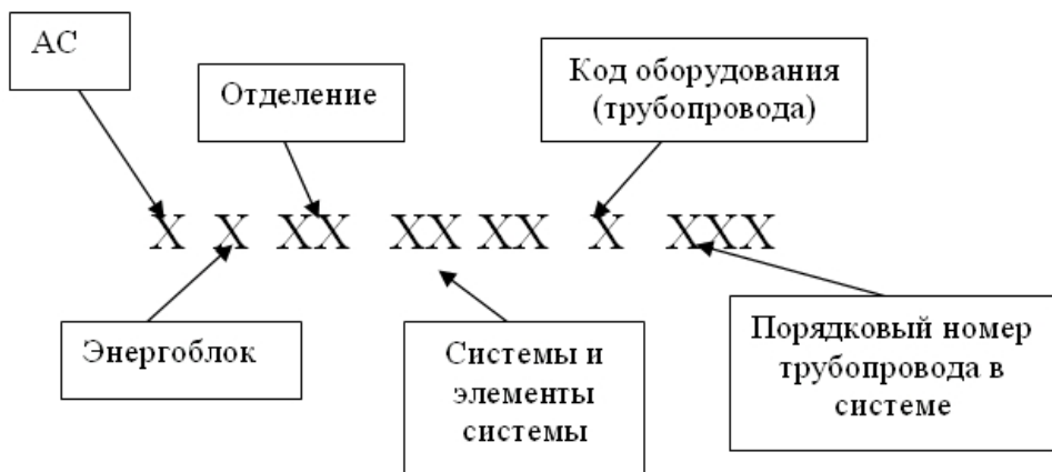
Рис. 1.2. Кодификатор трубопроводных систем АЭС.
