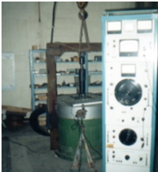
Рис.4.4. Демпфер на испытательном стенде.
