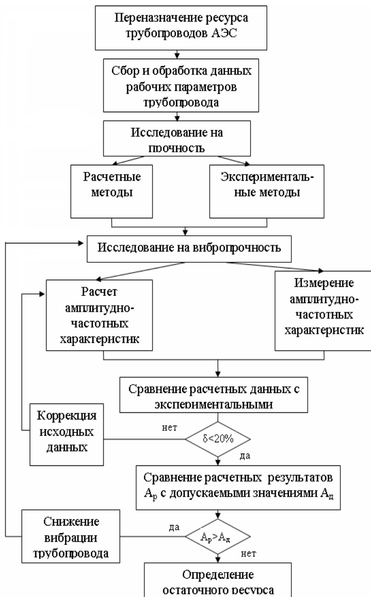
Рис.2.3. Алгоритм оценки остаточного ресурса трубопроводов с учетом параметров нагружения.
