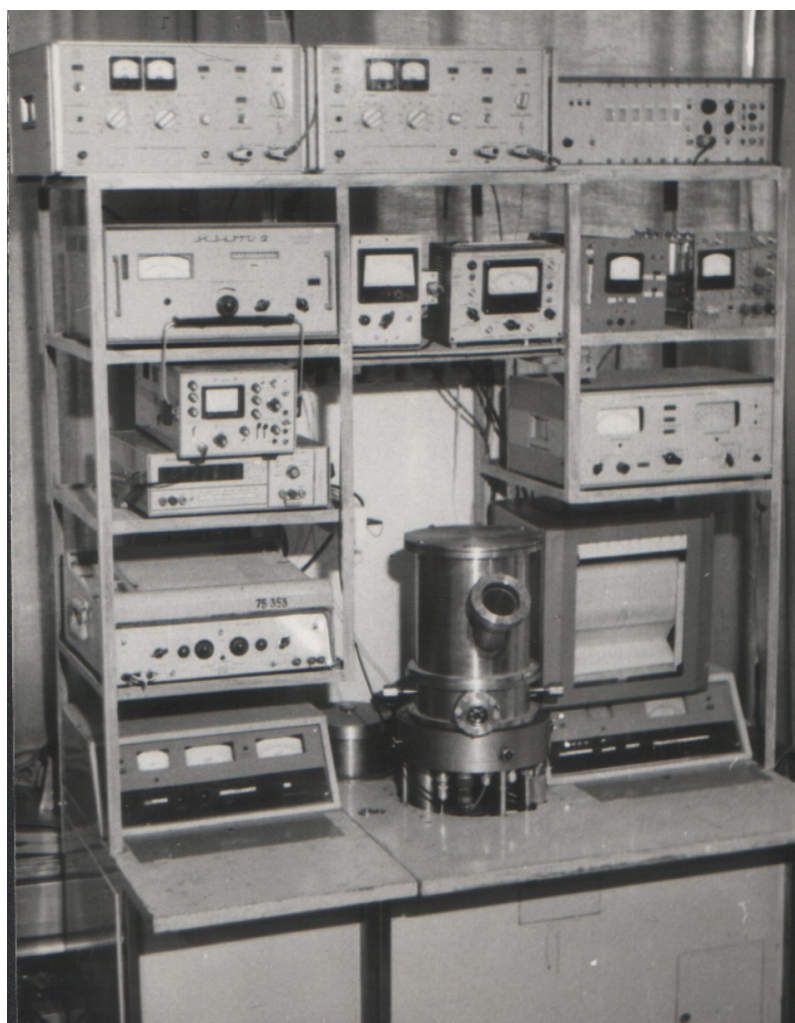
Установка для исследования и контроля тонких пленок методом термостимулированной экзоэлектронной эмиссии
