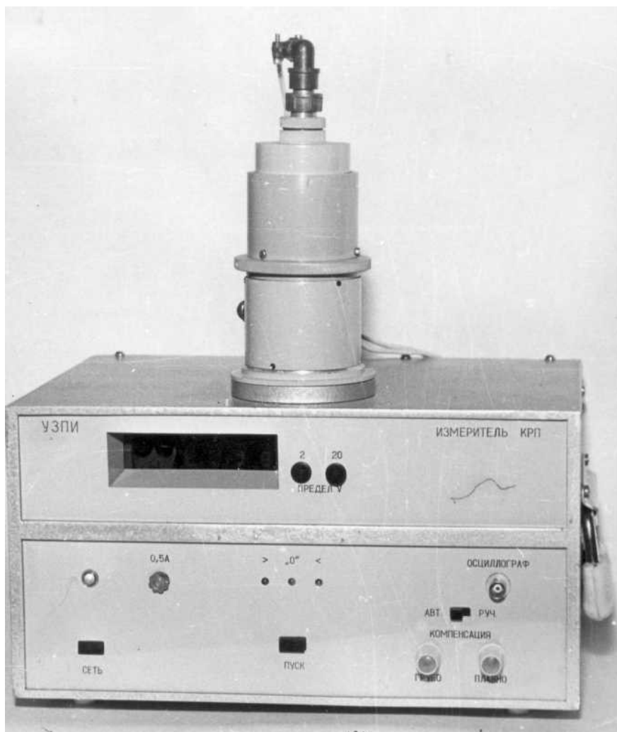
Устройство для измерения контактной разности потенциалов
