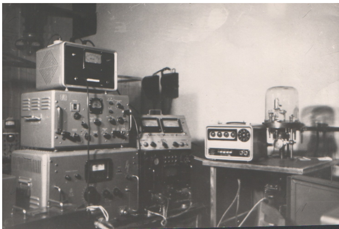
Установка для исследования экзоэлектронной эмиссии в газовой среде
